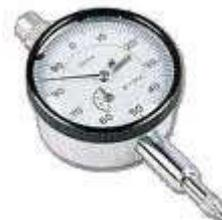
I comparatori normalmente vengono realizzati con corse utili comprese tra 1 e 100 mm, mentre la risoluzione è normalmente centesimale (0,01 mm), anche se vengono realizzati comparatori di precisione bimillesimali (risoluzione 0,002 mm).
