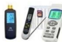
Tutti i misuratori di temperatura senza contatto hanno un raggio luce pilota per un migliore orientamento. I misuratori di temperatura senza contatto misurano solo la temperatura superficiale di superfici visibili, non possono misurare attraverso un vetro. Alcuni modelli hanno un grado di emissione fisso mentre in altri è possibile regolare il grado di emissione a seconda del materiale da misurare (carta, legno, superfici metalliche).
