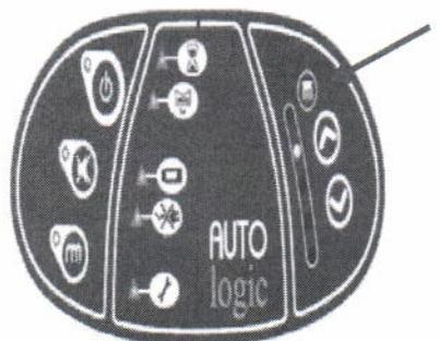
Attivando la funzione AUTO-FIRM gonfiaggio max, la superficie diventa per 15 minuti una piattaforma stabile per l'espletamento delle procedure infermieristiche e per supportare le esigenze di movimentazione e gestione del paziente. Trascorso tale intervallo, l'opzione si disattiva per ritornare automaticamente alla modalità precedente. La modalità Auto-Firm è prolungabile di 5 minuti per volta fino ad un massimo di 30 minuti.
