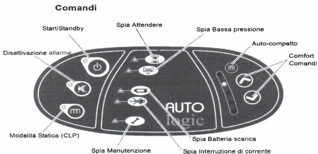
L'unità di controllo si avvale del sensore SELF SET TECHNOLOGY per controllare la pressione d'interfaccia.
