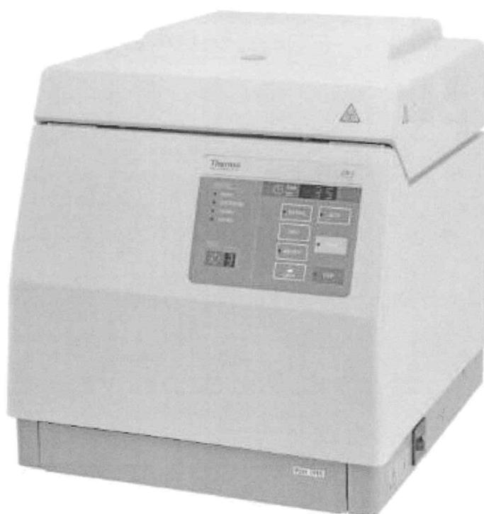
La nuova centrifuga CW3+ è in grado di gestire in modo estremamente preciso ed automatizzato il lavaggio delle cellule del sangue (emazie) fino a 24 campioni per singola corsa. Dal design compatto, dotata di rotori intercambiabili a 12 o 24 campioni, è in grado di processare i protocolli e le procedure standardizzate con grande riproducibilità.
